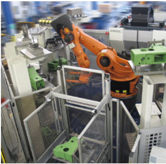
Flexible Fertigungszelle mit Palettenbahnhof. In der eigenen Fertigung werden Bearbeitungszentren von ALZMETALL eingesetzt.
