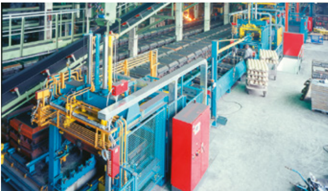
HWS-Hochdruckpress-Formanlage Formvolumen 900 x 800 x 600 mm Vollautomatisiert
