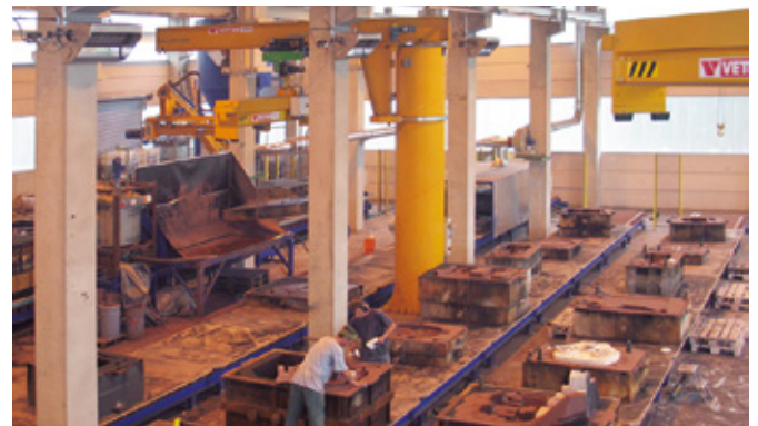
Kaltharz-Formanlage, Formvolumen 2200 x 1600 x 1500 mm
