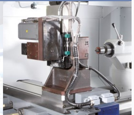
Y-Achse mit 200 mm Hub
