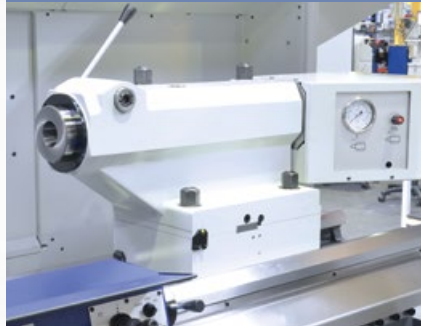
Reitstockpinole hydraulisch betätigt
