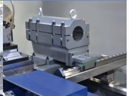
Bohrbock mit zusätzlicher Abstützung
