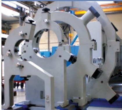
Lünetten bis Durchmesser 1.500 mm
