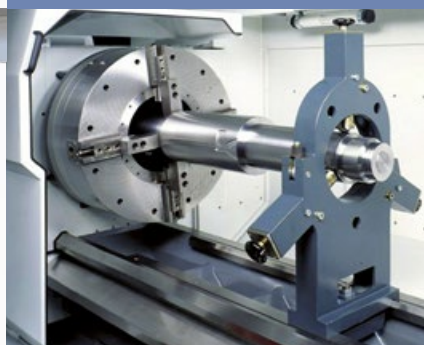
Pneumatisch betätigtes Vorderendfutter und feststehende Lunette
