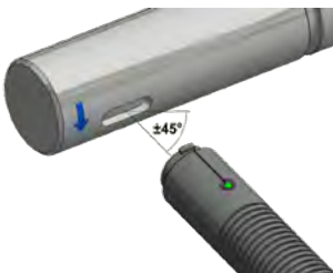
Rotierende Welle: Berührungslose Drehzahlmessung.
