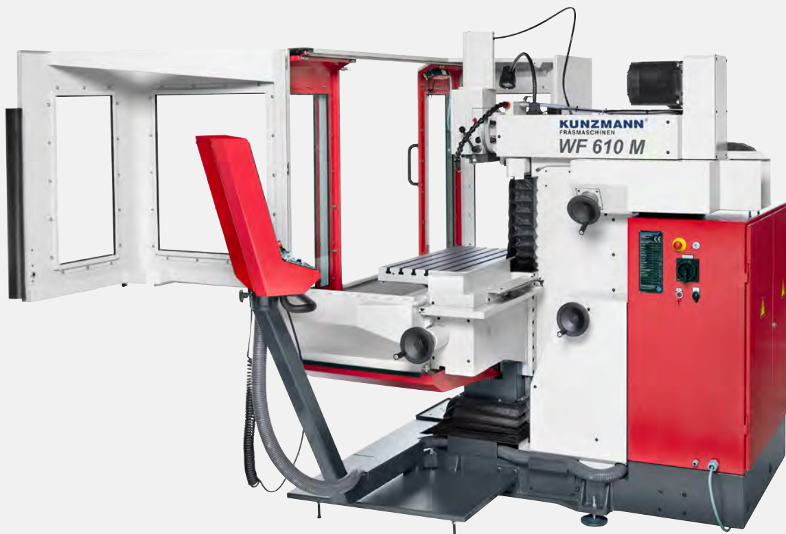
↑ Rechte Seitentür offen, Bedienung über manuelle Handräder mit 3-Achs-Digitalanzeige
