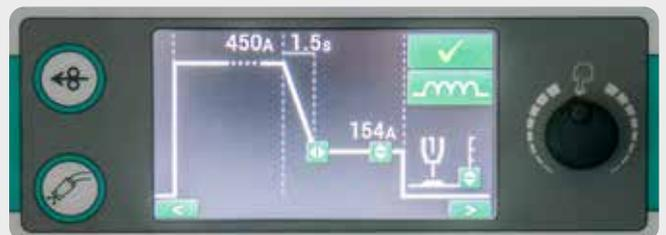
Drosselwirkung, Drahrückbrand und -einschleichen, Gasnach- & Gasvorströmzeit sowie Startstrom, Endstrom und Absenkezeit sind einstellbar.
