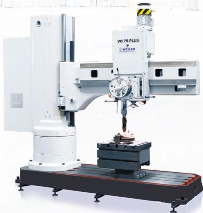
Die einfache Handhabung, große Stabilität, hohe Bohrleistung, das hohe Gewicht und große Verfahrswege sind die hervorstechenden Merkmale der WEILER Radialbohrmaschinen. Die Radialbohrmaschinen der VO-Reihe sind zum Bohren, Ausbohren, Ausreiben und Gewindeschneiden großer Werkstücke konzipiert. Sie finden Anwendung in der Einzelteil- sowie Serienfertigung und sind auch zum Einsatz in Produktionslinien geeignet.
