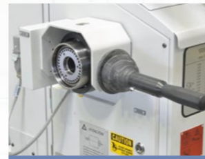
Dispositif de serrage rapide à levier pour pinces de traction
