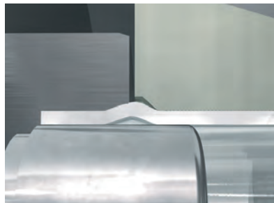
Die Kontur des Anschlusses wird durch die Geometrie der Werkzeuge bestimmt
