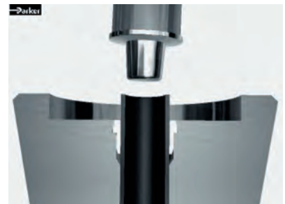
Dann wird das Rohr von den Backen eingespannt, der Bördeldorn bewegt sich nach vorne und führt eine Taumelbewegung aus
