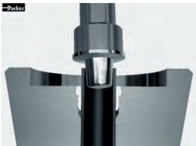
Während der Bewegung weitet der vordere Dorn die Rohrwand von innen auf
