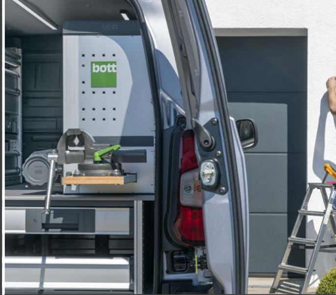
Ausziehbare Arbeitsplatte mit Schraubstock
