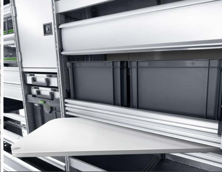
Schwenkbare Schreibplatte – integriert in die Fahrzeugeinrichtung
