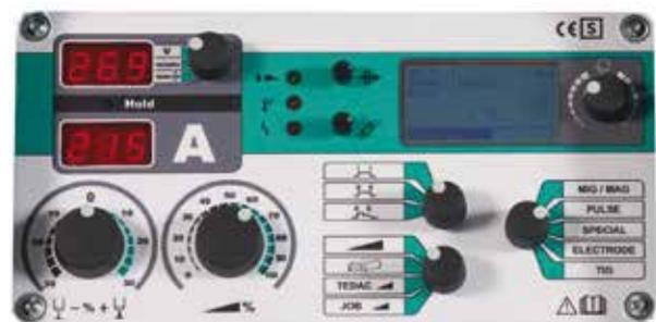
Programmwahl: Draht, Werkstoff und Gas über Display
