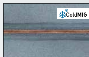
MIG-Löten mit geringer Wärmeentwicklung
