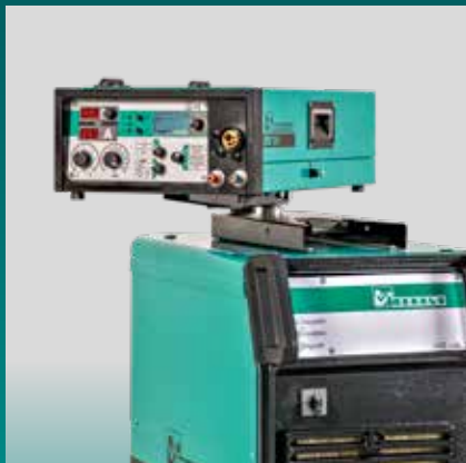
Asymmetrischer Drehpunkt mit optionaler Drehverbindung für größeren Arbeitsradius.
