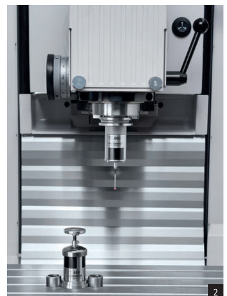
CNC-Teilapparat (1), Tastkopfsystem und automatische Werkzeugvermessung (2)
