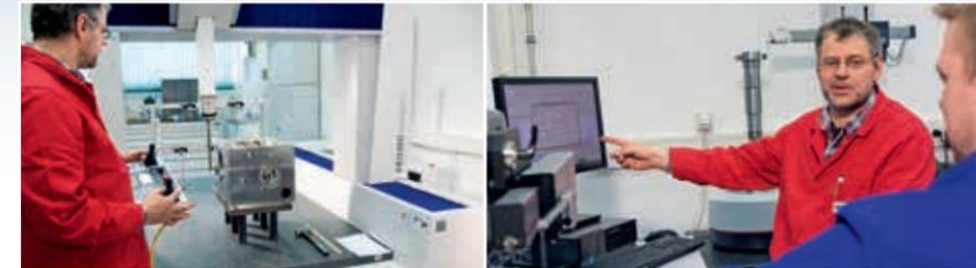
Der klimatisierte Messraum für die Präzisionsmessung aller funktionsrelevanten Teile
