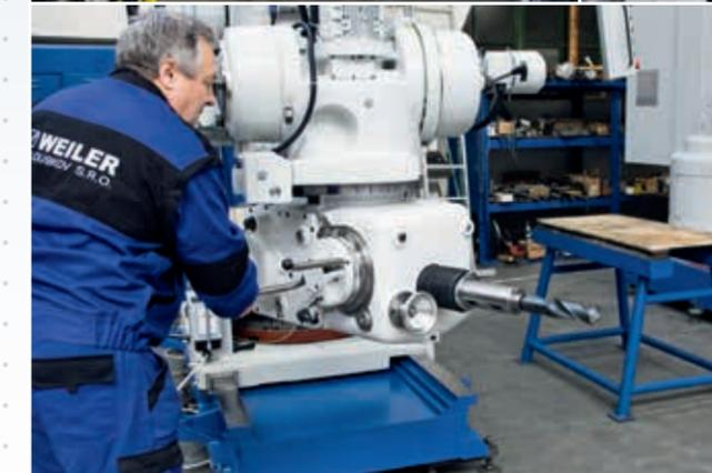
WEILER Holoubkov: Radialbohrmaschine in der Montage
