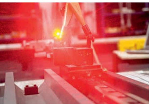
Einsatz modernster Laser-Messtechnik zur Kontrolle der Führungsbahnen
