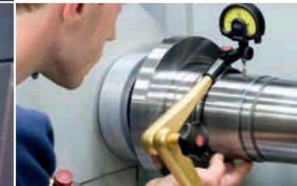
Messen der Rundlaufgenauigkeit. Die WEILER Fertigung garantiert die Einhaltung von  $\mu$ -genauen Toleranzen.
