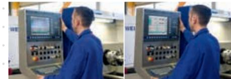
Schwenkbares Steuerungspult, Serienausstattung bei allen Werkzeugmaschinen der E-Reihe: Blendwirkung ausgeschlossen.
