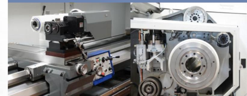
Tête de porte-outil pour opération de tournage, fraisage et perçage
