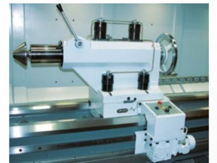
Poupée mobile avec blocage automatique et entraînement propre
