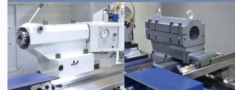
Fourreau contre-poupée à commande hydraulique
