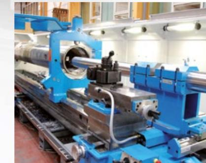
Porte-barre d'alésage renforcé avec appui additionnel et diamètre de logement 160 mm
