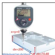
Bestimmung und Korrektur der Werkzeugausrichtung
