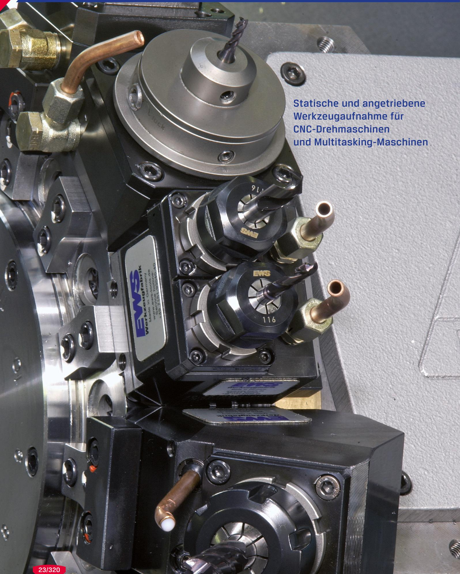
Stehende und angetriebene Präzisionswerkzeughalter für CNC-Drehzentren und Langdrehautomaten.
