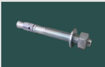
Bodenanker für Palettenregal-Rahmen + zur Bodenbefestigung + 12 mm Ø, 110 mm lang + zulässig für Betongüte C 20/25 + verzinkt oder Edelstahl
